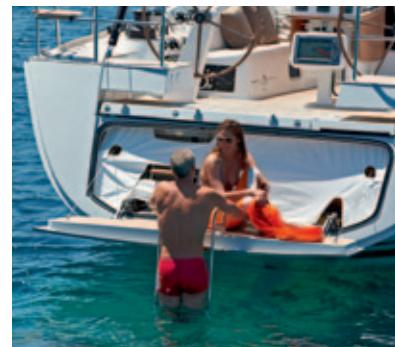
Idéale pour l'accès au bateau ou pour une baignade, la plateforme arrière est également la porte du garage à annexe.
